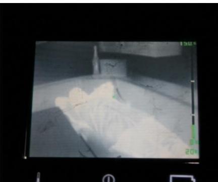
Die Wärmebildkamera ist ein unentbehrliches Hilfsmittel im Brandeinsatz beim Aufsuchen von Brandnestern sowie bei der Personensuche in verqualmten Räumen und wird auf beiden Löschfahrzeugen mitgeführt.
