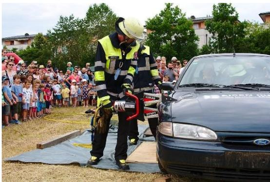
184kn maximale Spreizkraft und 927kn maximale Schneidkraft haben die schweren hydraulischen Rettungsgeräte unserer Löschfahrzeuge.
